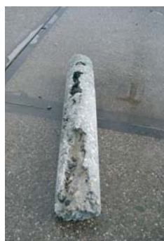
Figuur 8: Boorkern met een lengte van 2,5 m met het uitspoelinggat van onderaf gezien
