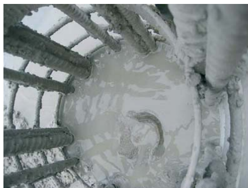
Figuur 8: Boorkern met een lengte van 2,5 m met het uitspoelinggat van onderaf gezien
